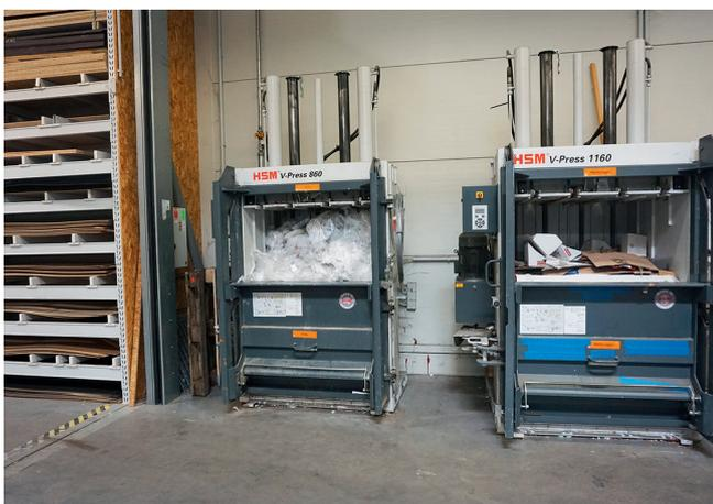
**Bild 2.** Vertikale Schrankballenpressen: Das Modell HSM V-Press 860 wird in diesem Beispiel für Folien eingesetzt, das Modell HSM V-Press 1160 für Papier und Kartonnagen, da davon mehr Material anfällt und diese Maschine die höhere Durchsatzleistung hat (© HSM)
